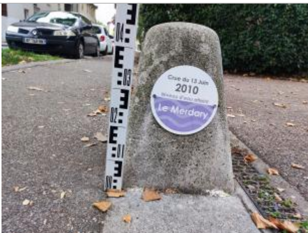
zoom sur le repère de crue posé avec une mire
