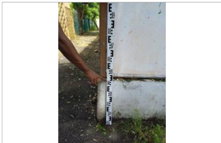
Témoignage d'une hauteur d'eau
