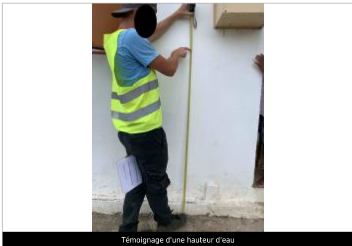
Témoignage d'une hauteur d'eau
