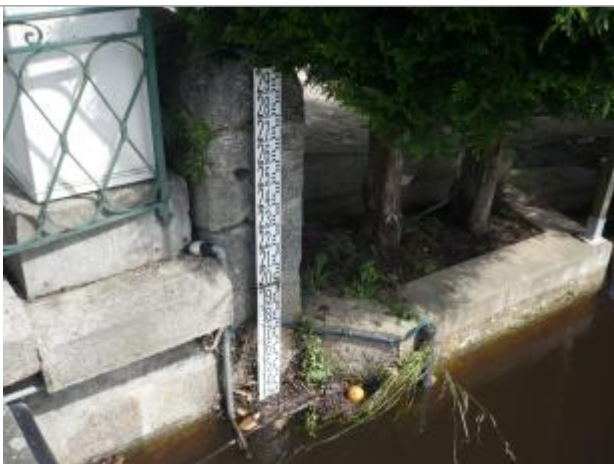
Vue rapprochée de la mesure à l'échelle de la station (Source : DDT 61).
