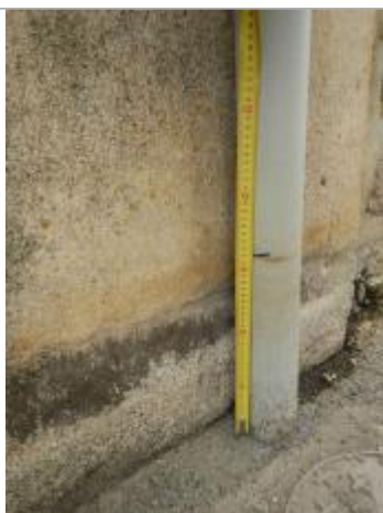
Vue d'ensemble de la laisse de crue sur descente de gouttière à hauteur du passage piéton.
