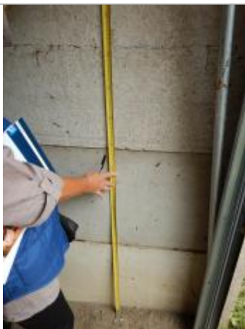
Prise de la laisse à l'intérieur du garage (Source : DDT 61)
