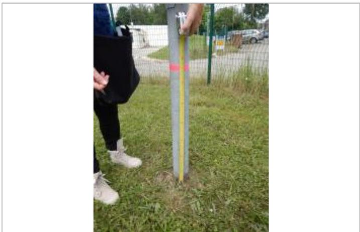
Prise de la mesure sur le poteau à partir du sol (Source : DDT 61)
