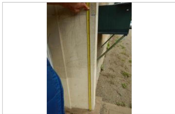
Prise de la mesure au niveau de la laisse (Source : DDT 61)
