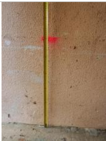
Mesure de la hauteur de la laisse depuis le sol en béton (Source : DDT 61)
