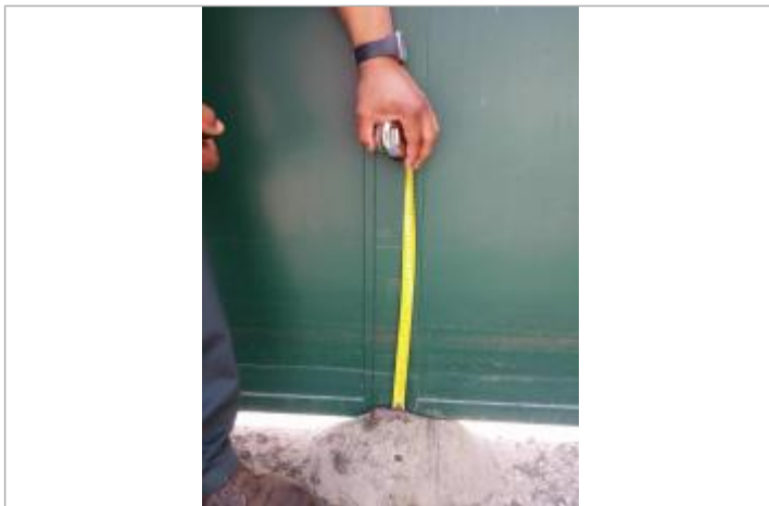
Prise de mesure de la laisse de crue depuis le dessus du butoir métallique du portail (source DDT 61)
