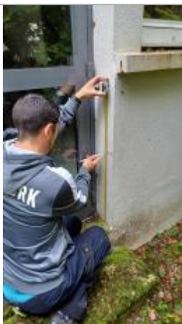
Laisse de crue inscrite sur le mur au marqueur à 52 cm/sol.
