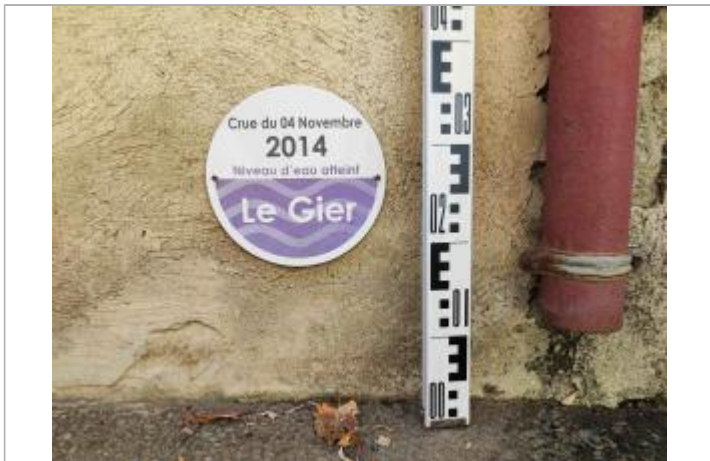
zoom sur le repère de crue posé avec une mire
