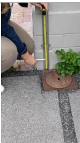
Laisse de crue sur le mur de la façade ouest de l'hôtel à 10 cm/sol.
