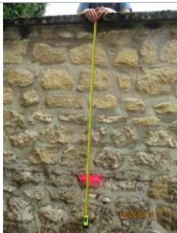
Laisse de crues sur le mur en pierre dans la descente de garage (source : DDT61)
