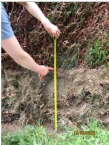
Mesure de la hauteur de la laisse par rapport au sol à 63 cm (source : DDT 61)
