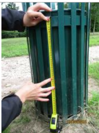
laisse de crue prise de haut en bas à partir de l'arceau supérieur de la poubelle publique : 30 cm (source DDT61)
