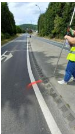
Laisse de crue sur la route.
