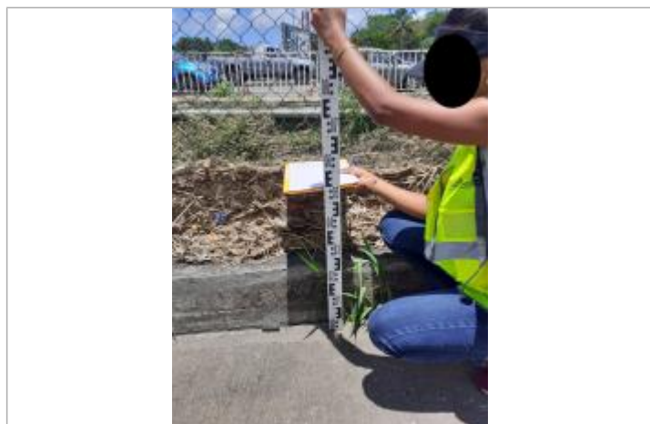
Dépôts de matières solides
