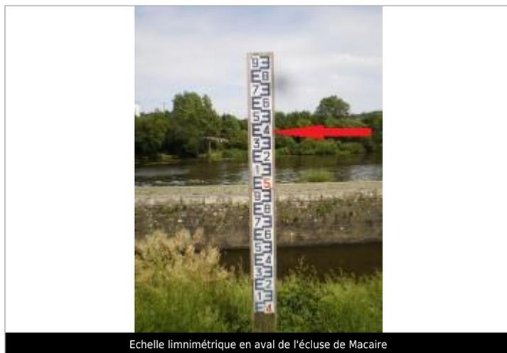
Echelle limnimétrique en aval de l'écluse de Macaire
