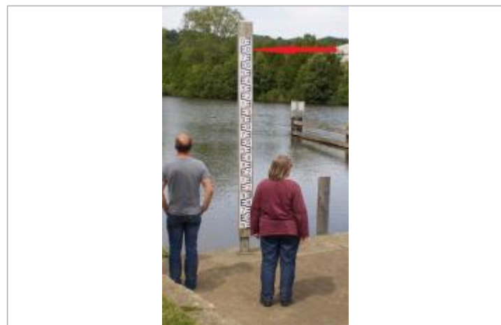
Echelle limnimétrique en amont de l'écluse de Macaire
