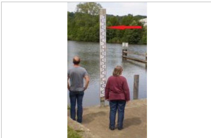
Echelle limnimétrique en amont de l'écluse de Macaire
