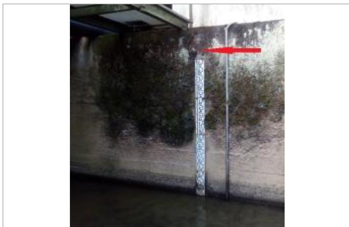
Echelle limnimétrique de la station du Néal à Médréac
