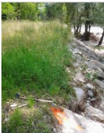
Vue du repère 'la trace orange représente le niveau atteint par les eaux) - Auteur : HEA/DDTM 64
