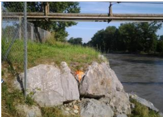
Vue du repère (la trace orange représente le niveau atteint par les eaux) - Auteur : HEA/DDTM
