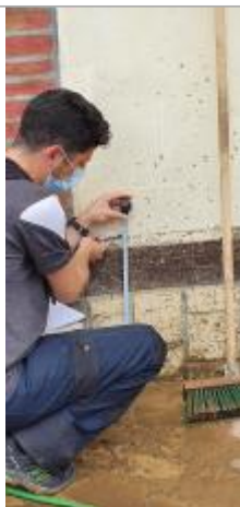
Laisse de crue sur mur sur façade de la maison à 55 cm/sol.
