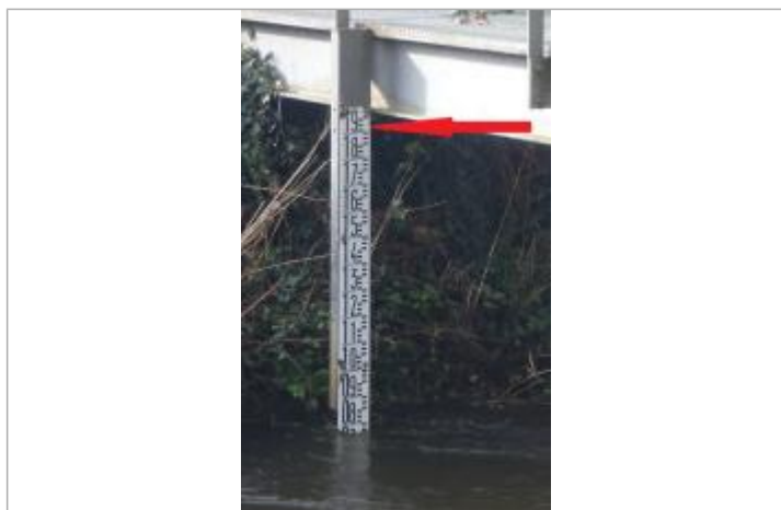
Echelle limnimétrique du Jet à Ergué-Gabéric (Kerjean)
