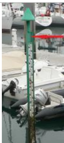
Echelle marégraphique du port de Bénodet
