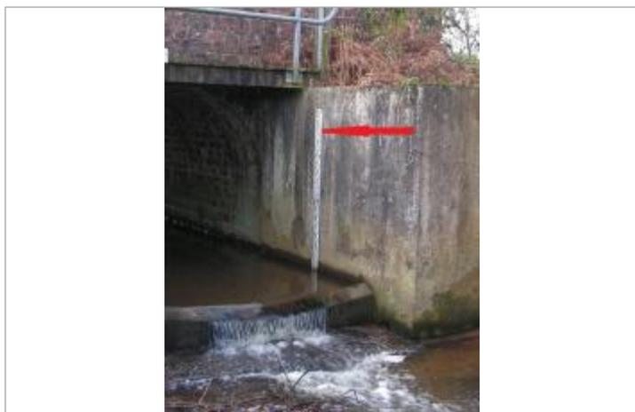
Echelle limnimétrique de la station Vigicruces de la Chèze à Plélan
