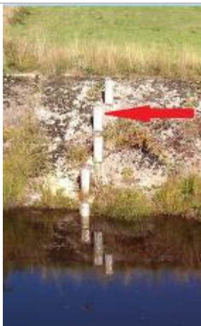
Echelle limnimétrique de l'Ellez en aval du barrage de Nestavel (Brennilis)
