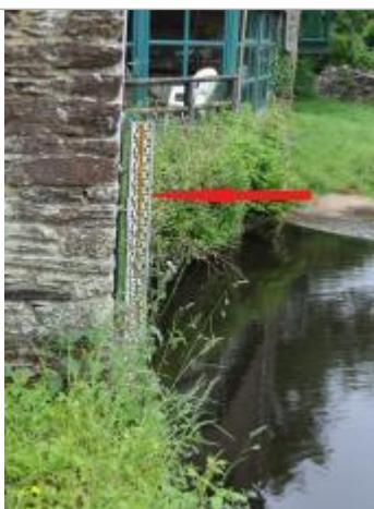
Echelle limnimétrique de l'Aulne à Pont-Triffen
