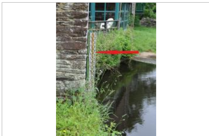
Echelle limnimétrique de l'Aulne à Pont-Triffen
