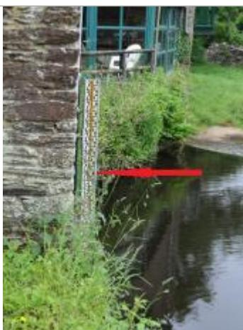
Echelle limnimétrique de l'Aulne à Pont-Triffen
