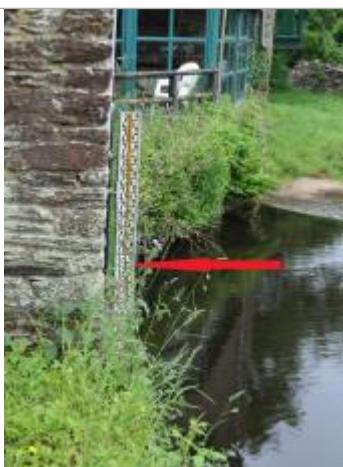
Echelle limnimétrique de l'Aulne à Pont-Triffen
