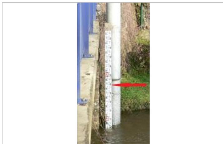
Echelle limnimétrique de la station de l'Aulne de Pont-de-Pénety
