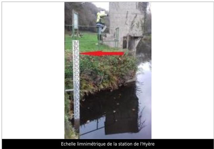
Echelle limnimétrique de la station de l'Hyère
