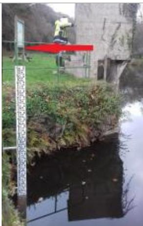
Echelle limnimétrique de la station de l'Hyère
