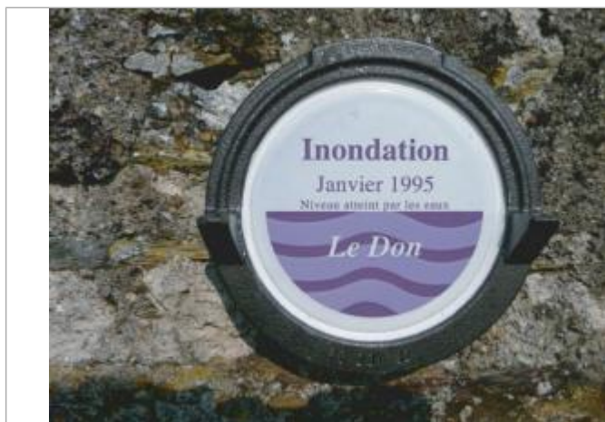
Repère normalisé de la crue de Janvier 1995
