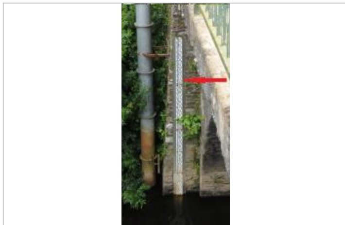
Echelle limnimétrique de l'Aulne à Chateauneuf-du-Faou
