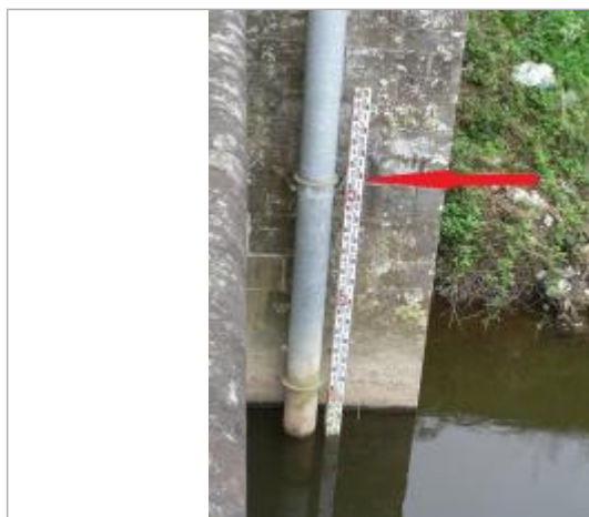
Echelle limnimétrique de l'Aulne à Gouézec Pont-Coblant
