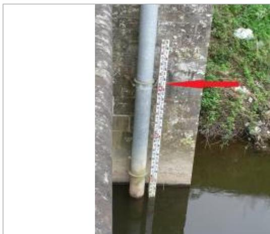
Echelle limnimétrique de l'Aulne à Gouézec Pont-Coblant
