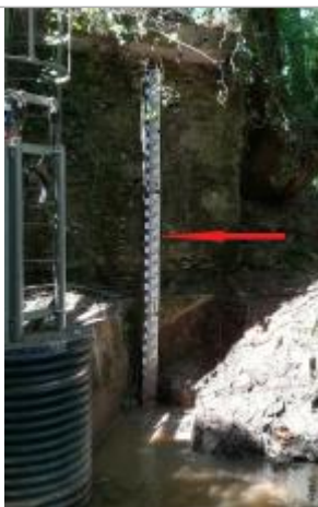
Echelle limnimétrique de la station de la Valière aux Rochers
