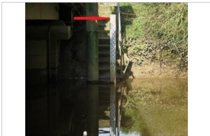
Echelle limnimétrique de la station sur l'Illet
