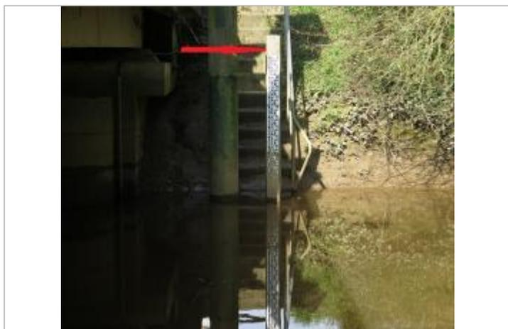
Echelle limnimétrique de la station sur l'Illet
