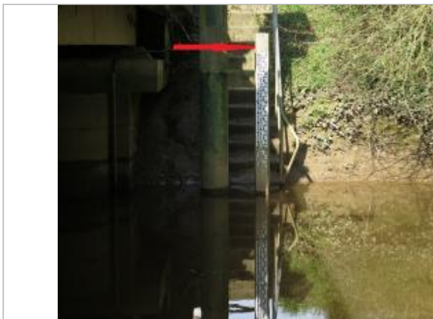
Echelle limnimétrique de la station sur l'Illet
