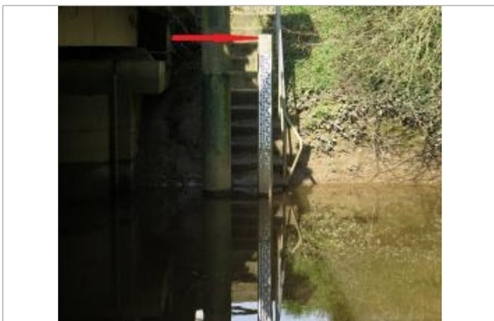
Echelle limnimétrique de la station sur l'Illet
