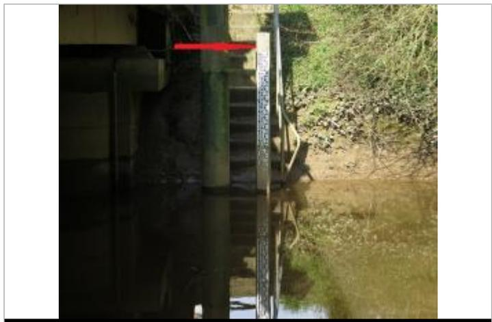
Echelle limnimétrique de la station sur l'Illet
