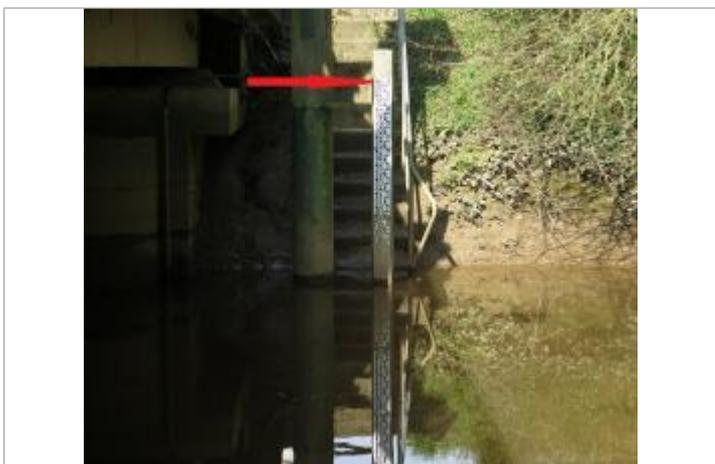
Echelle limnimétrique de la station sur l'Illet
