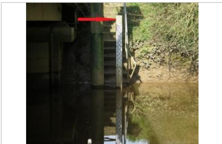
Echelle limnimétrique de la station sur l'Illet
