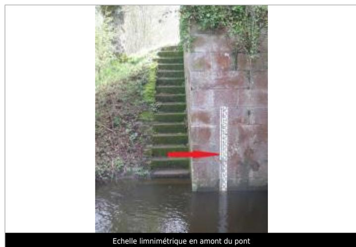
Echelle limnimétrique en amont du pont
