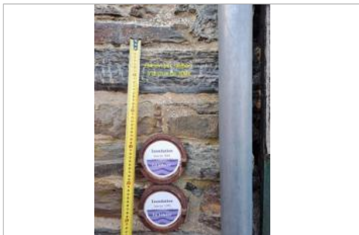
Relevé laisse différence 2025 et 2001 - photo du Conseil Régional de Bretagne - voies navigables
