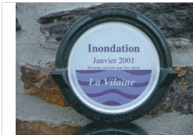
Repère normalisé de la crue de Janvier 2001
