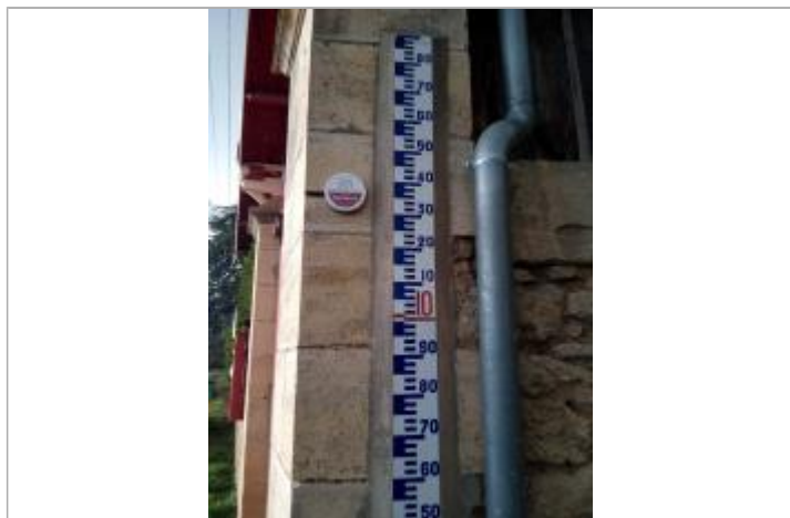
St Pierre d'Aurillac (33)_repère février 2021 aux Arrocs à côté d'une échelle de crue
