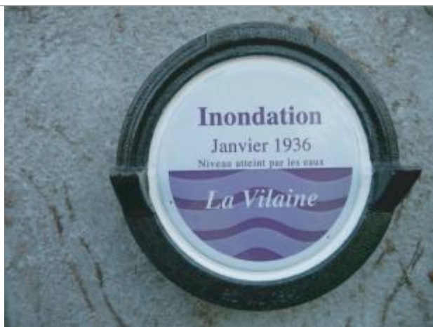
Repère normalisé de la crue de Janvier 1936
