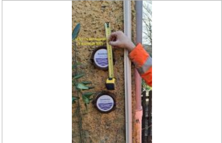
Différence entre la crue de 2025 et le repère de 2001 - photo Conseil Régional de Bretagne - voies navigables
