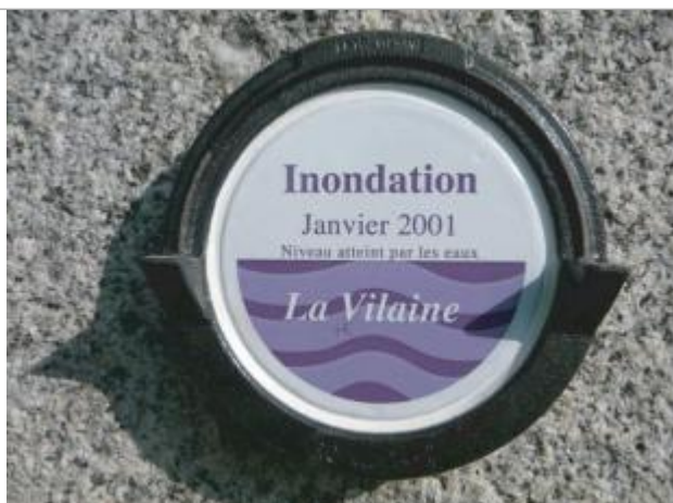
Repère normalisé de la crue de Janvier 2001
